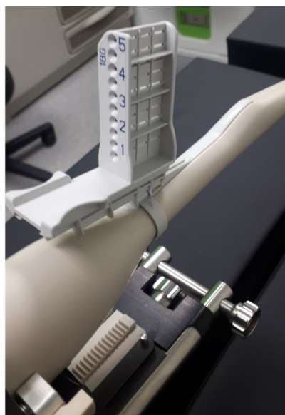
Фигура 21: EV29L с поставен стерилен водач за трансперинеална игла EV29L (показан е без обвивка)
